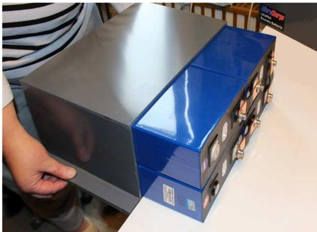
Die Batteriezellen so unter Zwischenlage der beiliegenden Dämpfungsplatten zur Isolierung nebeneinanderstellen, so wie sie später im Gehäuse eingebaut werden sollen, dann die Polverbinder anbringen und festschrauben. Den montierten Zellenblock dann auf die flache Seite so auf den Tisch legen, dass die Polanschlüsse von einem wegzeigen. Den auf der Seite liegenden Zellenblock etwas über die Tischkante ziehen, so dass man nunmehr von hinten das Gehäuse darüber
