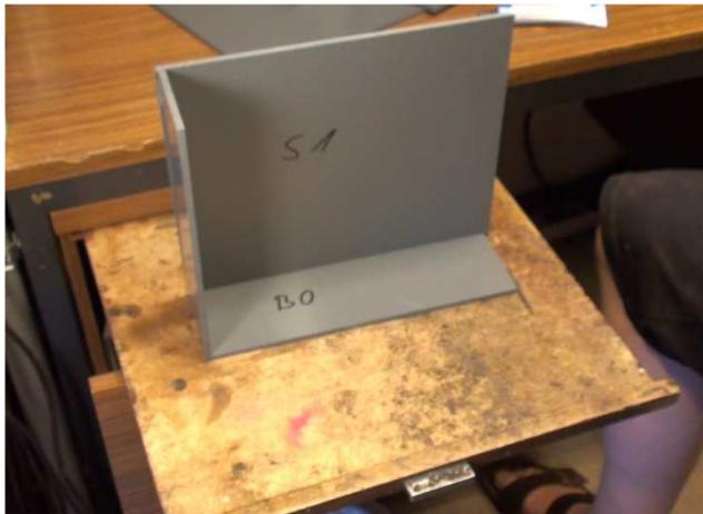
**2.** Am besten ist es, wenn man die große hintere Platte S1 einmal versuchsweise hinter das Bodenteil stellt. Dabei fällt auf, dass die hintere Platte S1 die Bodenplatte auf beiden Seiten um 5mm überragt. Diese 5mm auf jeder Seite entsprechen exakt der Dicke der beiden Seitenteile S2. Die hintere Platte S1 muss daher so an die Bodenplatte geklebt werden, dass der beidseitige Überstand von 5mm auf beiden Seiten **gleichmäßig** groß ist.
