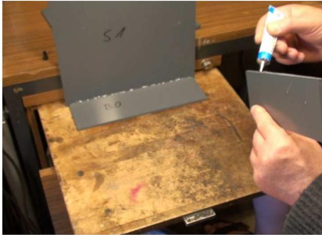
**5.** Seitenteil **S2** mit Kleber bestreichen (Schnittkante der langen Seite und offene Kante zur Bodenplatte).
