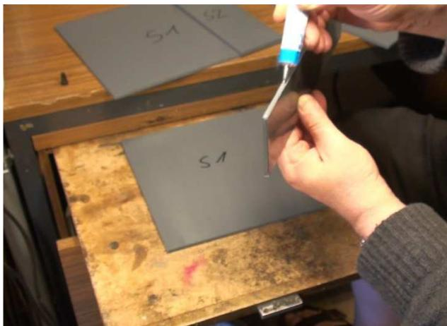
**3.** Die Bodenplatte **BO** wird nun an der Klebekante hinten (lange Seite) mit dem Kleber bestrichen.
