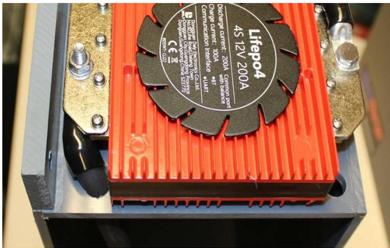
...und so wird dann das Minuskabel zur Batterie zusammen mit den Balancerkabeln und dem NTC durchgefädelt.
