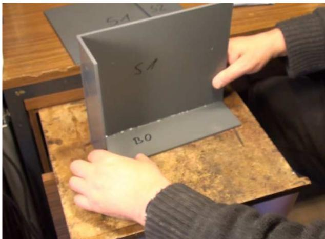
**6.** Seitenteil **S2** einfügen. Dabei an Bodenplatte **B0** und hintere Platte **S2** andrücken. Darauf achten, dass die Abstände der Kanten zueinander ordentlich fluchten. Herausquellenden Kleber **nicht abwischen!** Er würde bei dem Versuch nur das Gehäuse verschmutzen!
