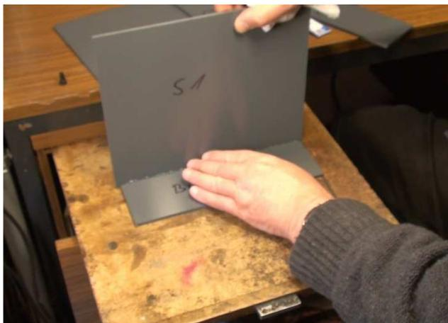
**4.** Bodenplatte auf die Arbeitsunterlager legen und die hintere Platte **S1** dagegen schieben. Dabei wie gesagt darauf achten, dass die Überstände links und rechts gleich groß ausfallen (jeweils 5mm). Hintere Platte **S1** an die Bodenplatte **BO** andrücken, damit überschüssiger Kleber herausgedrückt wird. Hintere Platte dabei senkrecht halten und am besten mit einer Flasche o.ä. so abstützen, dass sie genau 90° senkrecht zur Bodenplatte steht und nicht umfällt.
