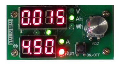
Zusätzlich wird die bisher dem Akku entnommene "Arbeitsmenge" in Wh (Wattstunden) angezeigt. Arbeit ist das Produkt der Leistung (W) mit der Zeit (h) und entspricht der Energiemenge, die mit der Luftströmung vom Kühlkörper über die Dauer der Entladung an die Umgebung abgegeben wird. In der Praxis wird man mit diesem rein rechnerischen Wert nicht viel anfangen können. Ich erwähne es nur der Vollständigkeit halber.
