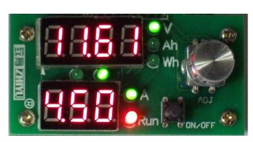
Wird die zuvor eingestellte Entladeschluss-Spannung erreicht, beendet sich das Entladeprogramm automatisch. Die Anzeige der entnommenen Kapazität in Ah blinkt schnell und die Anzeige des Entladestroms zeigt "---".
