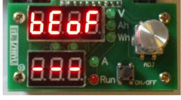
Damit ist die Grundeinstellung abgeschlossen und man befindet sich im normalen Einstellmenü für Entlade-Strom und Entladeschluss-Spannung.
