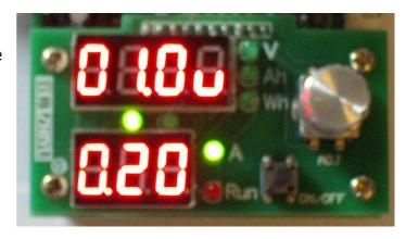
Durch Drücken des Drehknopfes erlischt die linke grüne LED und es leuchtet die rechte grüne LED über der "3". Dies zeigt an, dann nun der Strom in **0,01A-Schritten** eingestellt werden kann. Soweit gewünscht, Einstellung vornehmen.
