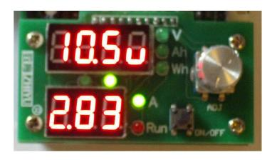
LED "A" erlischt und wechselt auf LED "V" oben. Die linke grüne LED unter der "5" zeigt an, dass die Entladeschluss-Spannung nun in Schritten von 1V gewählt werden kann. Mit dem Drehknopf die gewünschte Entladeschluss-Spannung einstellen, dann Drehknopf drücken. Die grüne LED springt nach rechts. Nun kann die Entladeschluss-Spannung in 0,1V-Schritten eingestellt werden. Danach Drehknopf drücken und das Einstellprogramm beginnt von vorn.
