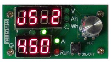
Nach dem Start des Entladeprogramms schaltet das Messgerät den unten angezeigten Entladestrom ein und beginnt mit der Messung, was durch die rote "Run"-LED signalisiert wird (nächstes Bild).
