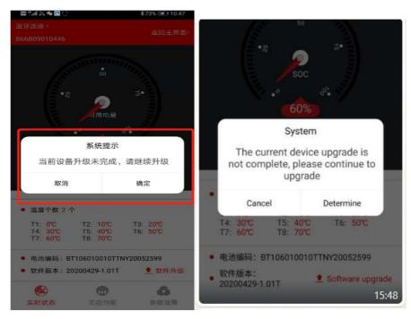
相反,如果蓝牙 ID 退出重新链接进去后,不弹出对话框,证明 BMS 固件程序并没有丢失,不需要点击后凝视的软件升级字样
