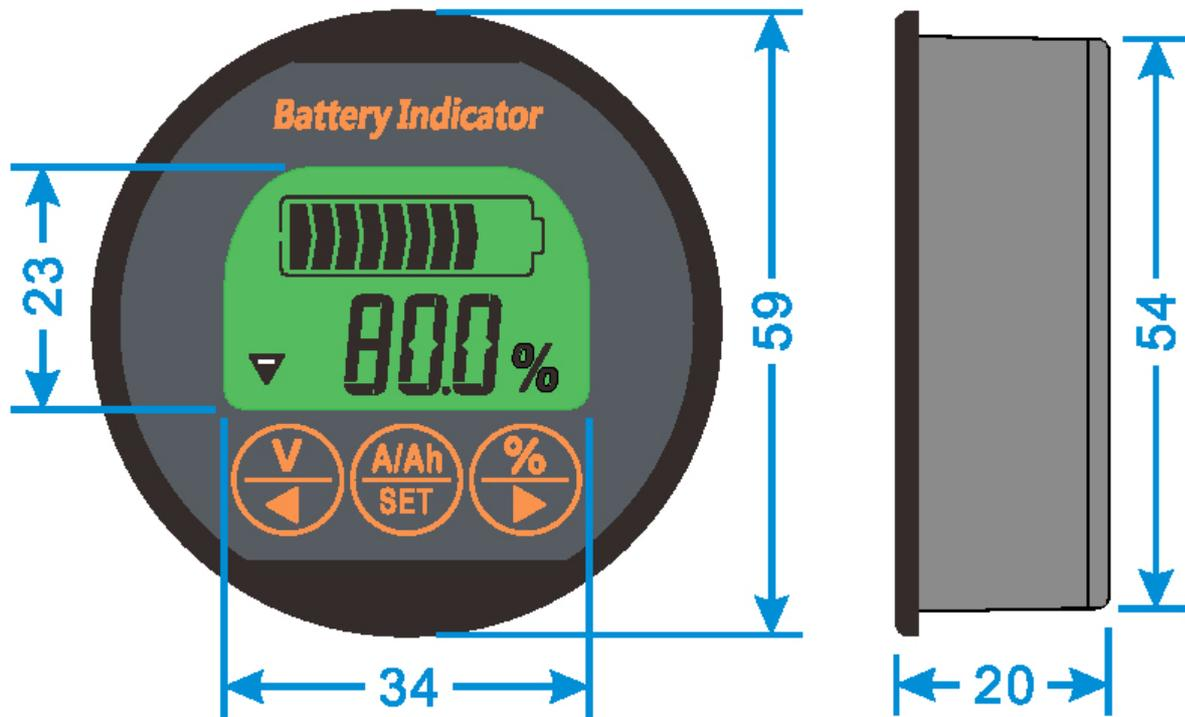
Der TR16 ist ein besonders preiswerter Batteriecomputer im praktischen Gehäuse eines klassischen Rundinstruments, der Spannung, Strom, Stromrichtung, Leistung und Ladezustand der Batterie anzeigt. Der Ladezustand wird dabei einerseits in % und andererseits direkt in Ah angezeigt, so dass der Verwender stets über den genauen Ladezustand seiner Batterie informiert ist.
