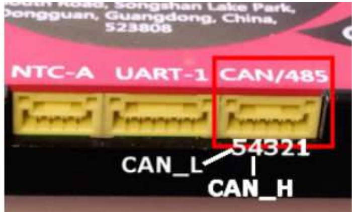
Damit das Kabel verwendet werden kann, muss die Steckbuchse rechts im Bild mit „**CAN/485**“ beschriftet sein.
