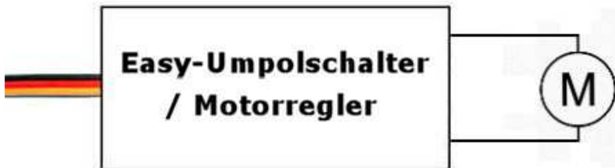
Der zu schaltende Motor wird direkt am Schalter angeschlossen. Plus und Minus sind nicht gesondert ausgewiesen, da der Ausgang beim Umpolen ja ohnehin die Polarität ändert. Die Stromversorgung des Motors wird direkt der Empfängerspannung entnommen. Die maximale Strombelastbarkeit des Easy-Umpolschalters beträgt 1,5A.
