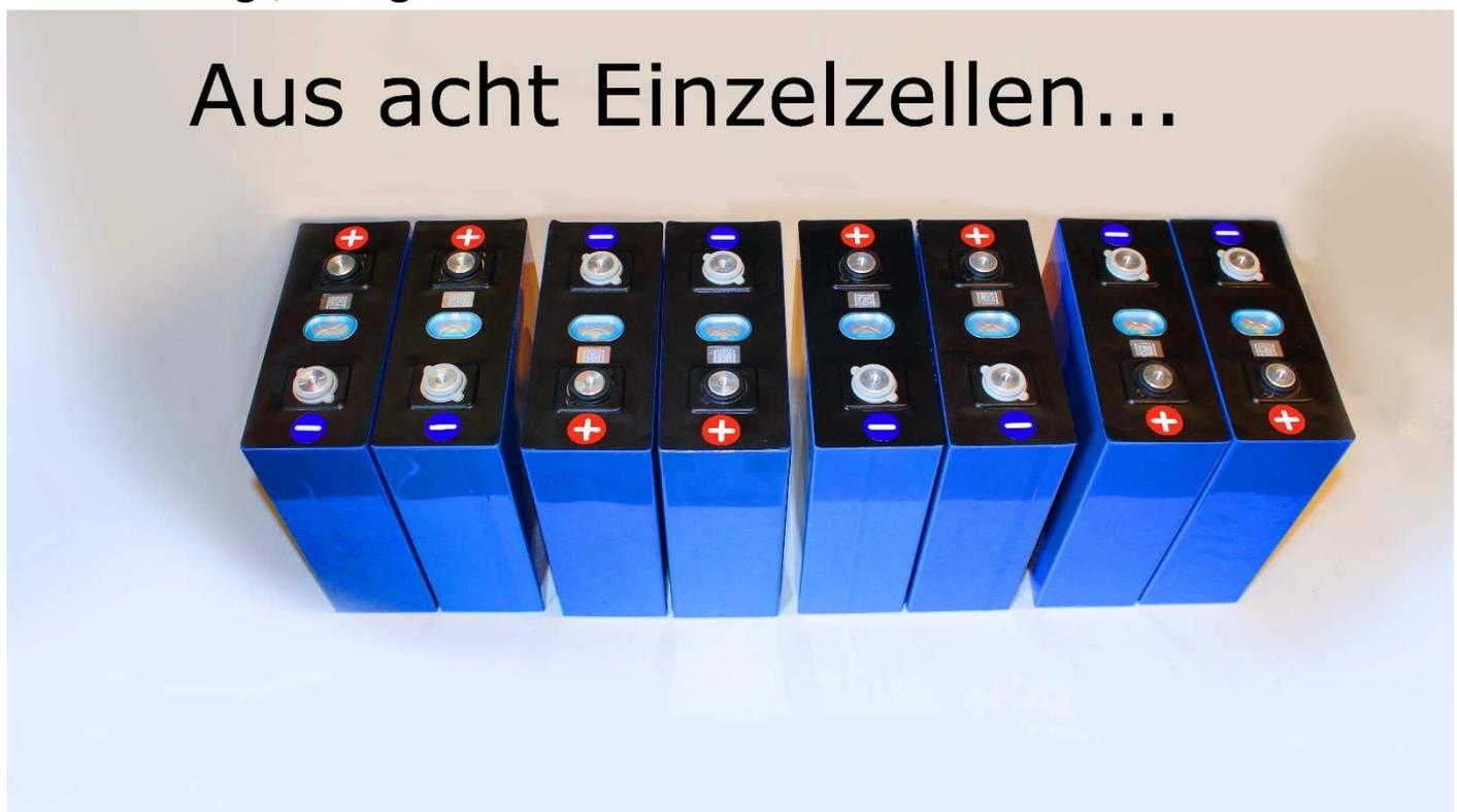
Zellenpaare polungsgleich zusammengestellt, von Paar zu Paar wechselt die Polarität. Dies ist für die spätere Reihenschaltung der vier Zellenblöcke wichtig.
