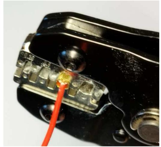
9. Das Ergebnis sollte aussehen wie auf dem Bild und eine saubere Kontaktierung und sehr zugfeste Verbindung ergeben. Zur Prüfung nachsehen, ob wirklich die abisolierte Kabelader kontaktiert wurde und zur Kontrolle kräftig an der Leitung ziehen. Wenn sie sich herausziehen lässt, taugt die Verdringung nichts.
