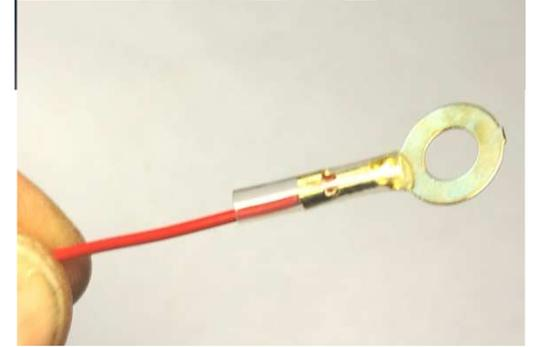
11. Isolierschlauch mit Heißluftpistole oder Feuerzeug schrumpfen. Nicht schwarzbrennen!
