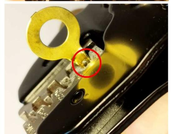
8. Kabelschuh herausnehmen und einen Pressschacht weiter nach vorn rücken. Kabelschuh genau so einlegen, dass er vorn und hinten bündig mit dem Presswerkzeug abschließt
