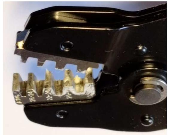
2. Damit die Kabelschuhe in die kleinen Pressbacken passen, müssen die Flügel am Ende etwas zusammengedrückt werden. Einfach mit zwei Finger etwas zusammendrücken.
