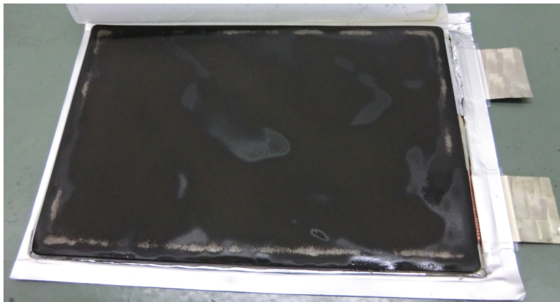
Abbildung 2.13: Erkennbares Lithium-Plating anhand silbrig metallischem Lithium am Rand der Graphitanode.
