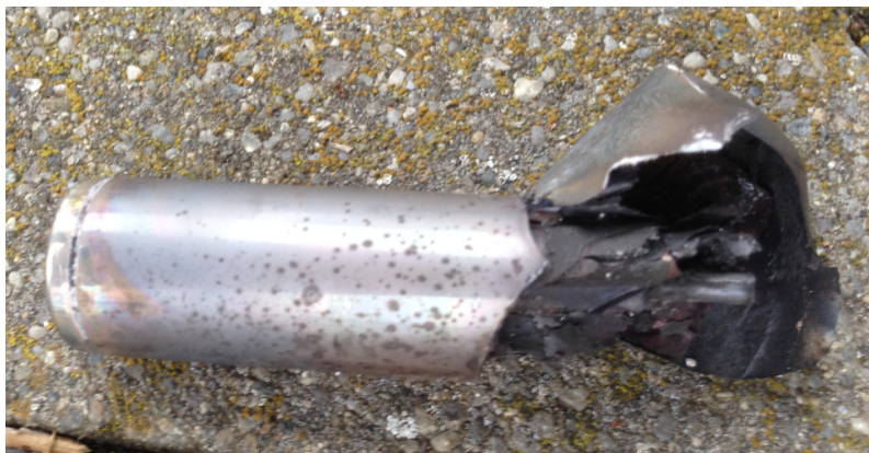
Abbildung 2.10: 18650-Lithium-Ionen-Zelle nach dem thermischen Durchgehen.
