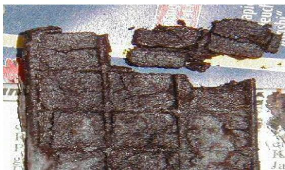
ABBILDUNG 11: VOLLSTÄNDIG KORRODIERTE GITTERPLATTE [MIC03]
