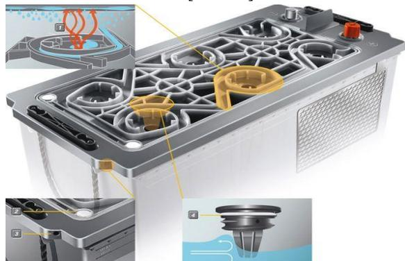
„Der Wasserdampf kondensiert am Batteriedeckel (1). Das Wasser fließt dann durch das Labyrinth Deckel-Design in die Batterie zurück. Der Rückzündschutz (2) schützt die Batterie vor Funken. Über die Zentralentgasung (3) werden entstehende Gase laut Hersteller sicher abgeführt. Wie ein Wellenbrecher soll der Sicherheitsstopfen (4) im Inneren der Batterie arbeiten.“
