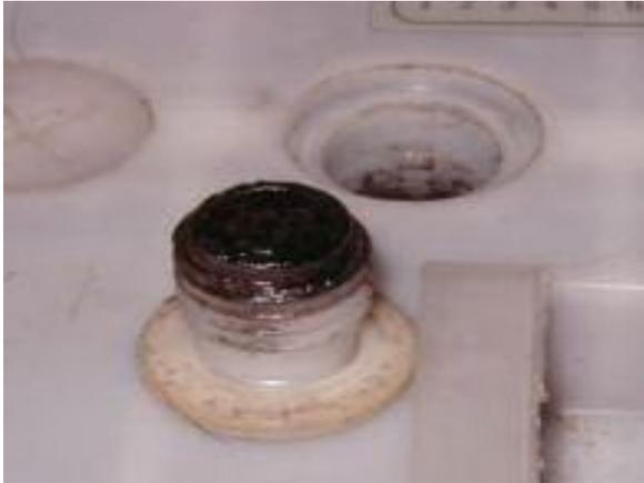
ABBILDUNG 12: ABSCHLÄMMUNG AM ZELLENSTOPFEN [MIC04]
