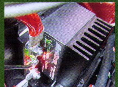
Die grüne LED signalisiert eine zum Laden geeignete Bordspannung, die rote LED zeigt den Ladevorgang der sekundären Batterie an.
